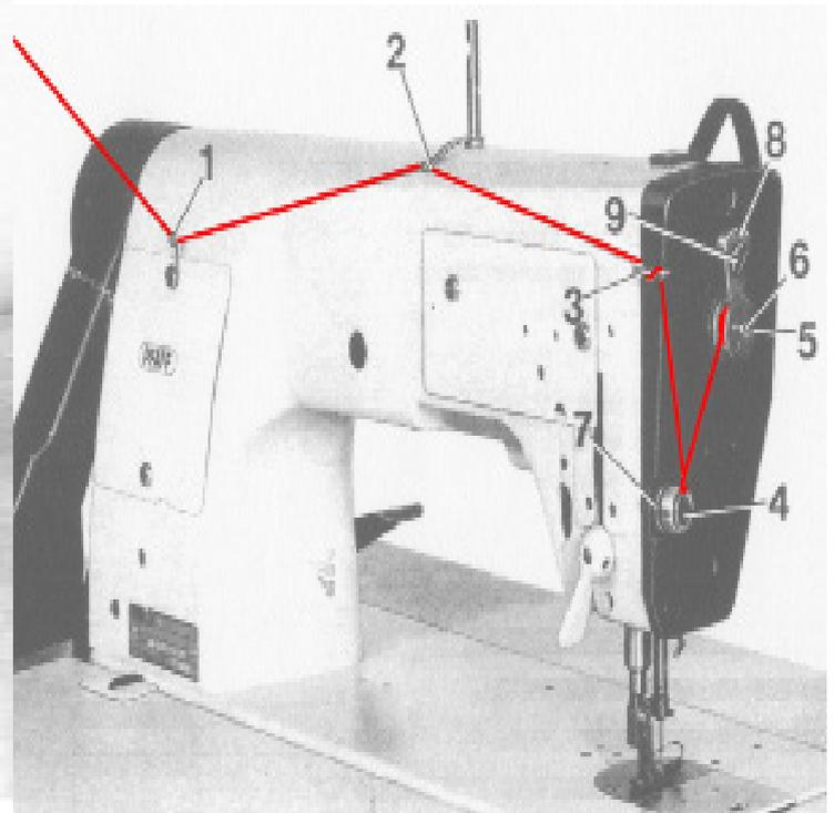
Faden entsprechend Abb. einfädeln
