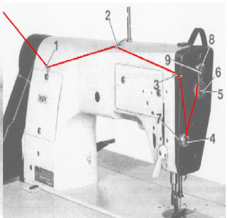
Faden entsprechend Abb. einfädeln
