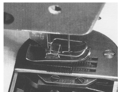
Unterfadenspule aus Spulenkapself herausnehmen
