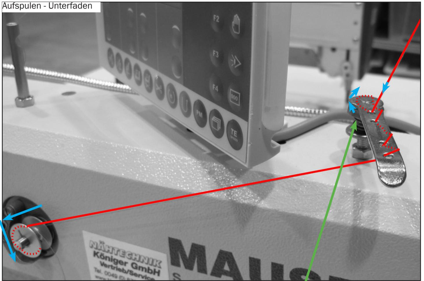
Faden um die Klemmfeder führen
