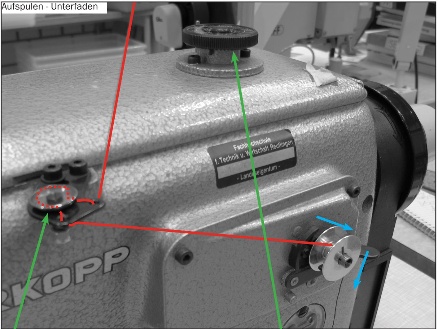
Faden um die Klemmfeder führen
