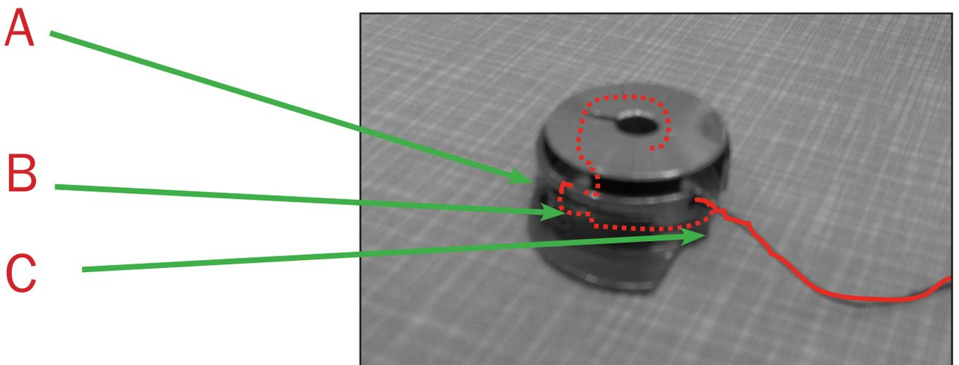
Nachdem die Spulenkapsel mit der Spule in die Maschine eingelegt wurde muss der Unterfaden durch drehen des Handrades nach oben geholt werden!
