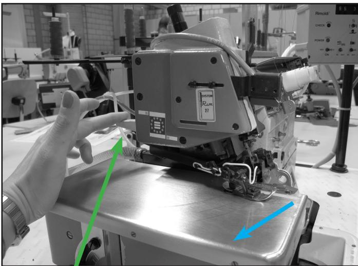
Durch drücken des Hebels kann der Fuß seitlich nach links bewegt werden
